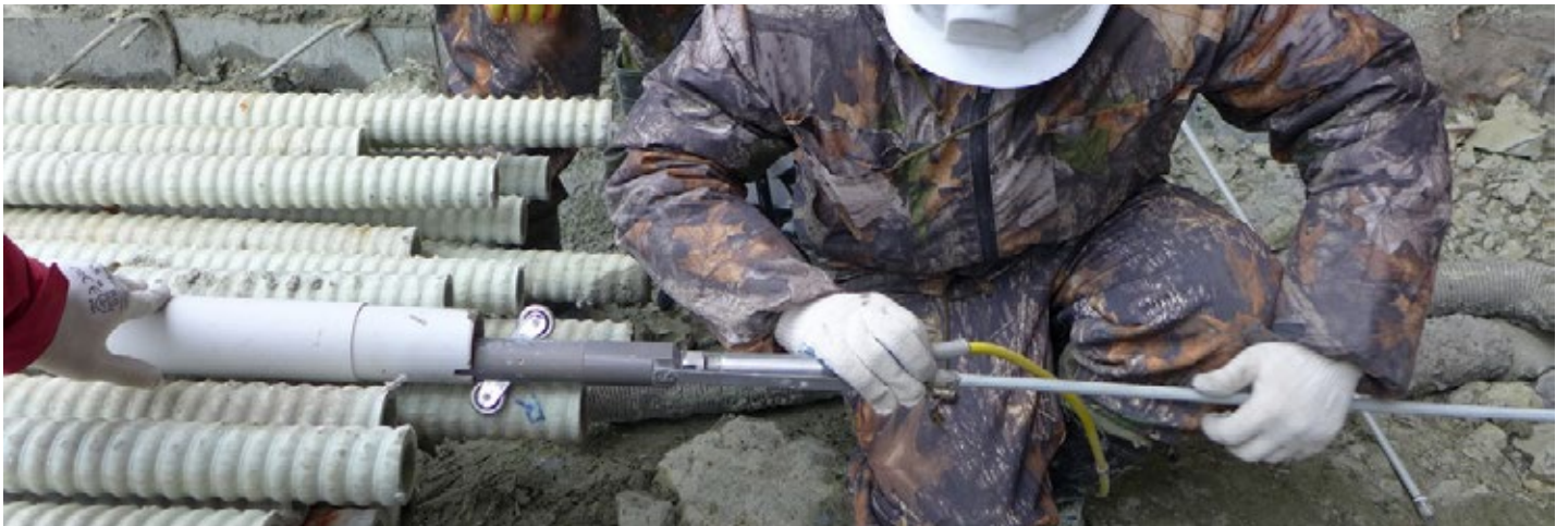
Préparation de la sonde T-REX pour mesure horizontale
